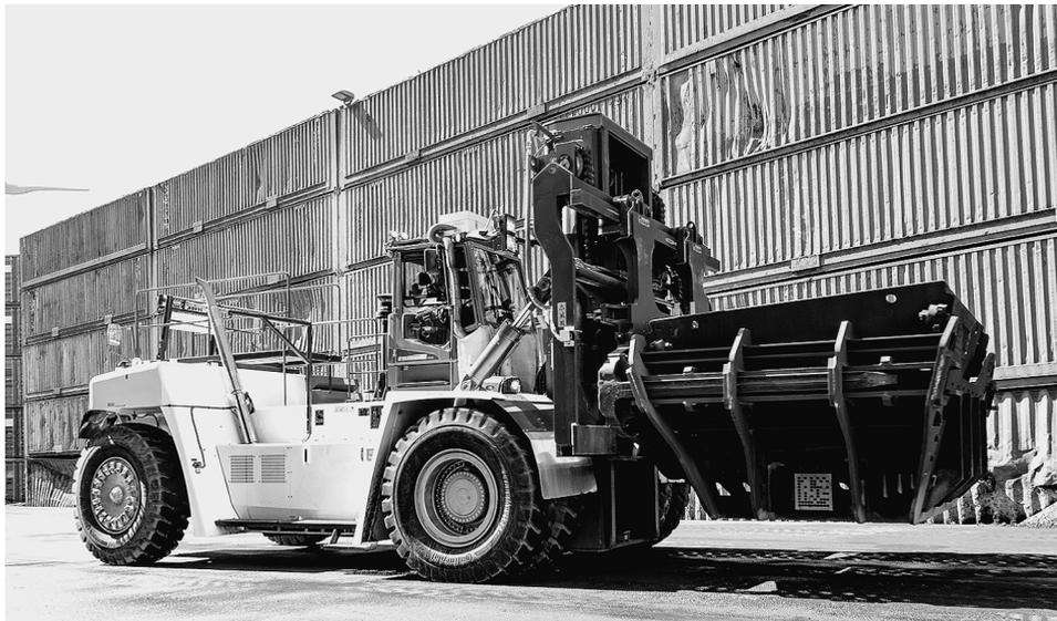
Die Drehgeräte von Kaup werden in den Niederlanden zum Entleeren tonnenschwerer Schlackebehälter genutzt.
